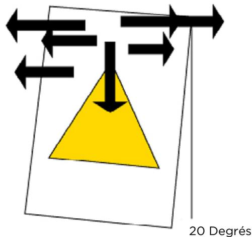
L'air peut facilement rester coincé entre la surface adhésive et le substrat. Un poseur d'enseigne qui garde une ouverture près de la raclette pourra diminuer les risques d'apparition de bulles d'air.
